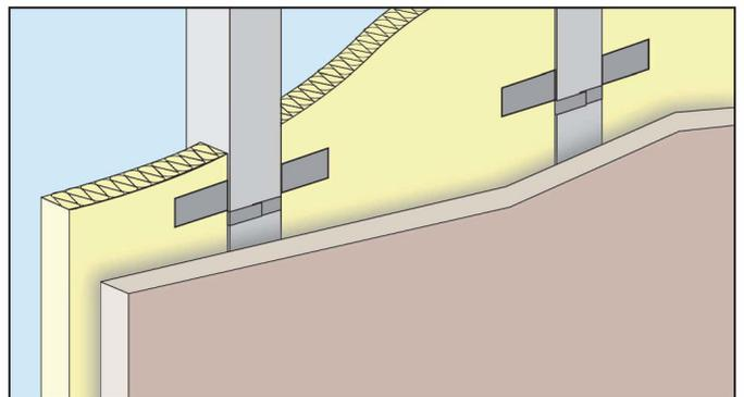
フカシ壁、二重壁など遮音材を既存壁、隠ぺい壁に接触することなく、空気層を確保して施工が出来る。
